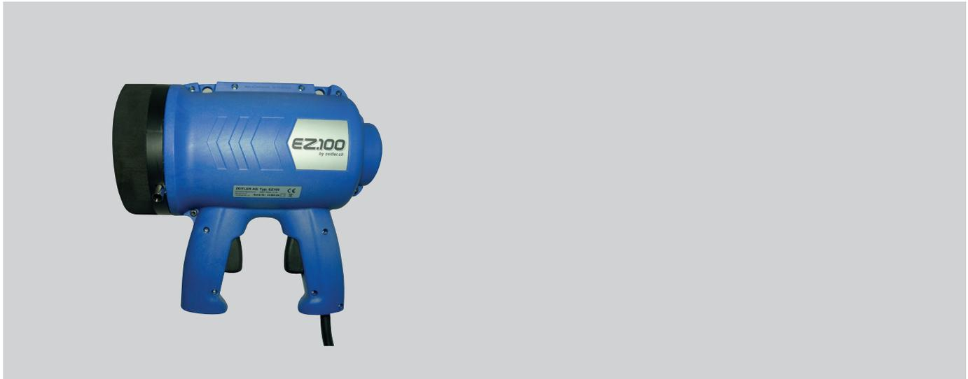
Das Schnureinzuggerät EZ100 von Zeitler wurde speziell für Kabelnetz-Ersteller im Bereich Erdreich/Strassen-, Tunnel- sowie Brückenbau entwickelt. Die Einzugschnur kann sowohl eingeblasen wie auch angesaugt werden. Wasser, loser Schmutz oder Kleinteile werden im gleichen Arbeitsgang ausgestossen.
