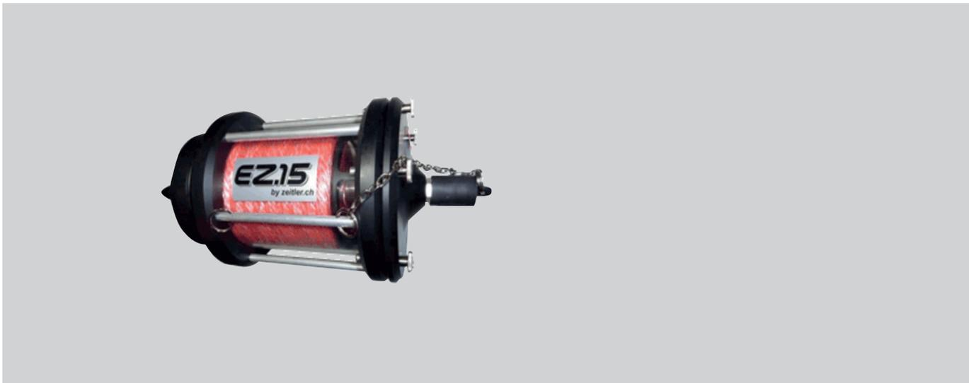
Das Schnureinzuggerät EZ15 von Zeitler eignet sich speziell für den Schnureinzug bei kurzen Distanzen (bis ca. 500 m) in Mikrorohre von Ø 4 bis 20mm (Innenrohrdurchmesser). In nur 30 Sekunden findet die Schnur im Luftzug den Weg durch ein 500 m langes Rohr.
