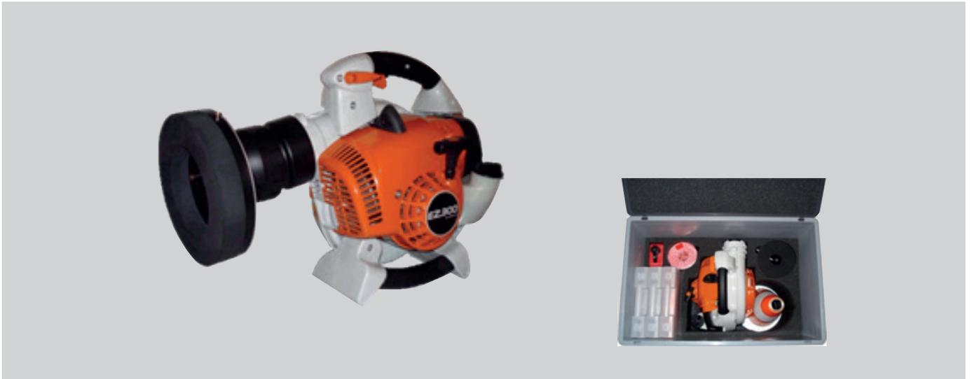
Das Schnureinzuggerät EZ300 von Zeitler braucht keinen Elektroanschluss. Mit dem leistungsfähigen 2-Takt-Motor wird die Einzugschnur stromunabhängig eingeblasen oder angesaugt. Zum Einsatz kommt das Gerät im Bereich Tunnel-, Erdreich/Strassen- sowie Brückenbau, Bergbahnen und Seilbahnbau. Es eignet sich für Kabelschutzrohre Ø 25 bis 200 mm (Innenrohrdurchmesser). Wasser, loser Schmutz oder Kleinteile werden im gleichen Arbeitsgang ausgestossen.
