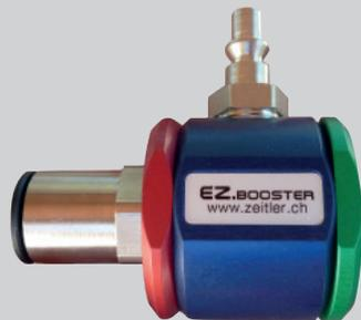
Vorrichtung zum druckluftunterstützten Einschieben von LWL Kabeln ( $\varnothing$  0.5 mm bis 8.0 mm) in Mikrorohre. Mit dem EZ.BOOSTER können mit Hilfe eines handelsüblichen Kompressors LWL-Kabel schnell und sicher in Mikrorohre eingeschoben werden. Einschublänge bis ca. 500 m. In Kombination mit dem EZ.SPEEDY kann die Leistung sogar noch verbessert werden.
