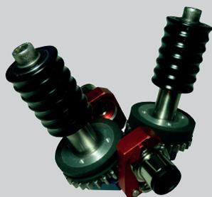
Vorrichtung zum maschinell-unterstützten Einschleiben von LWL Kabeln ( $\varnothing$  0.5 mm bis 8.0 mm) in Mikrorohre. Mit dem EZ.SPEEDY können mit Hilfe eines handelsüblichen Akkuschraubers LWL-Kabel schnell, sicher und ohne abknicken in Mikrorohre eingeschoben werden. Einschublänge bis ca. 500 m. In Kombination mit dem EZ.BOOSTER kann das Kabel sogar noch sanfter und gleichmässiger eingeschoben werden.
